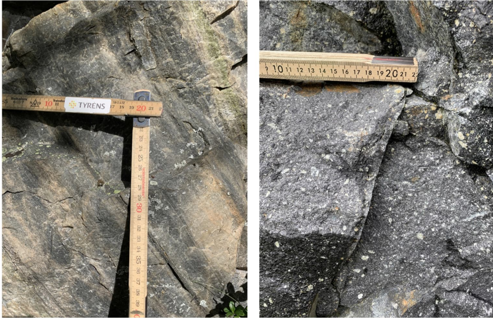
Figur 2. På vänstra bilden syns ett exempel på fältspatrik kvartsit och till höger ottfällsdiabas med phenocryster av plagioklas.
